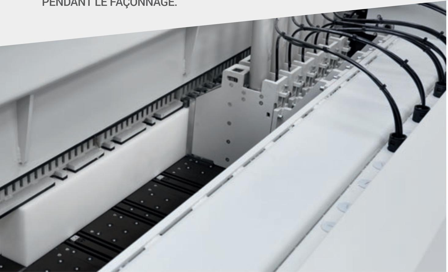
Le double presseur présente une structure dédoublée et indépendante, qui garantit une pression homogène et contrôlée sur la pile de panneaux à découper grâce à l'absence d'ouvertures pour le passage des pinces, créant un véritable compartiment étanche dans les coupes de délignage afin d'obtenir une aspiration efficace des poussières.
